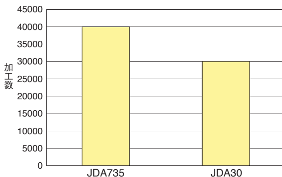
アルミ合金フライス加工の結果
